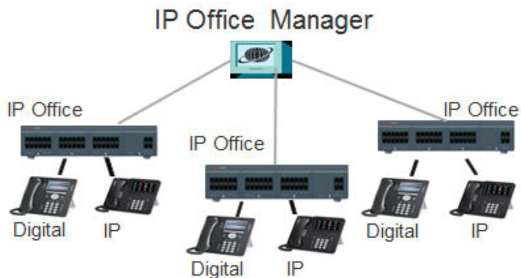
Figura 1: Sistemi IP Office connessi a un singolo terminale IP Office Manager
